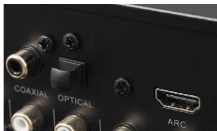
Wśród wejść cyfrowych nie ma USB-DAC, ale jest HDMI ARC zyskujące na praktycznym znaczeniu.
